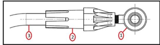
4. Fixer à nouveau la tige de commande aux commandes en utilisant l'autre côté de l'unité comme référence si nécessaire. L'écrou doit être serré à un couple de 12 à 15 pi-lb.
