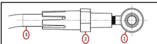
3. Visser le nouveau coupleur cannelé (2) sur la tige de commande (3) manuellement jusqu'à ce qu'il s'arrête (environ 16 tours). Visser ensuite le palier à embout (1) dans le coupleur fileté (2) manuellement jusqu'à ce qu'il s'arrête (environ 19 tours).
