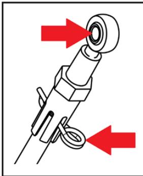
2. Dévisser le palier à embout (1) du coupleur (2), puis dévisser le coupleur (2) de la tige de commande (3). Mettre au rebut le coupleur « non cannelé ».
