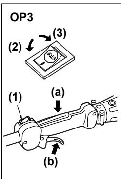
4. Positionnez interrupteur d'arrêt sur "MARCHE". Placez l'unité sur une surface plate et solide. Isolez la fixation de lame des objets environnants. (OP3)
