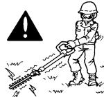
1. Faire tourner le moteur à la vitesse appropriée à la coupe sans jamais accélérer inutilement au dessus du niveau nécessaire.
