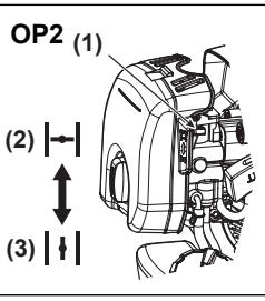
3. Mueva la palanca del estrangulador a la posición de cierre. (OP2)
