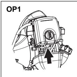
2. Appuyer plusieurs fois sur la pompe d'amorçage jusqu'à ce que de l'essence s'écoule par le tuyau de trop-plein (OP1).
