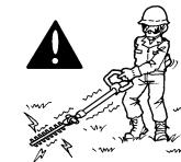
1. Mantenga la velocidad del motor al nivel necesario para realizar el trabajo de corte, y nunca aumente la velocidad del motor por encima del nivel requerido.
