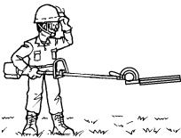
2. Lorsque vous transportez l'appareil à la main, recouvrir la partie coupante si nécessaire, soulever le produit et le porter en faisant attention à la lame.
